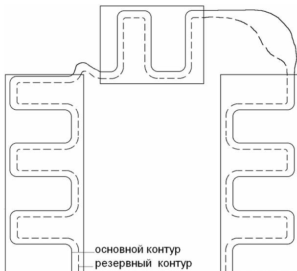
Нагревающий провод освободить от фольги. Основной и резервный контур могут быть зафиксированы на некотором расстоянии друг от друга битумной мастикой.
