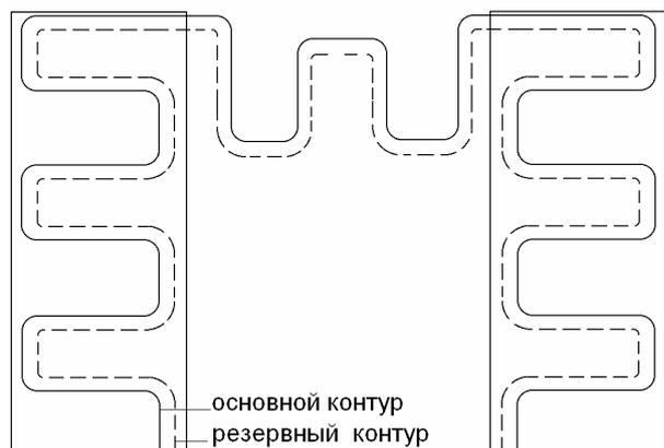
Нагревающий провод освободить от фольги и уложить без нее. Основной и резервный контур могут быть зафиксированы на некотором расстоянии друг от друга битумной мастикой.
