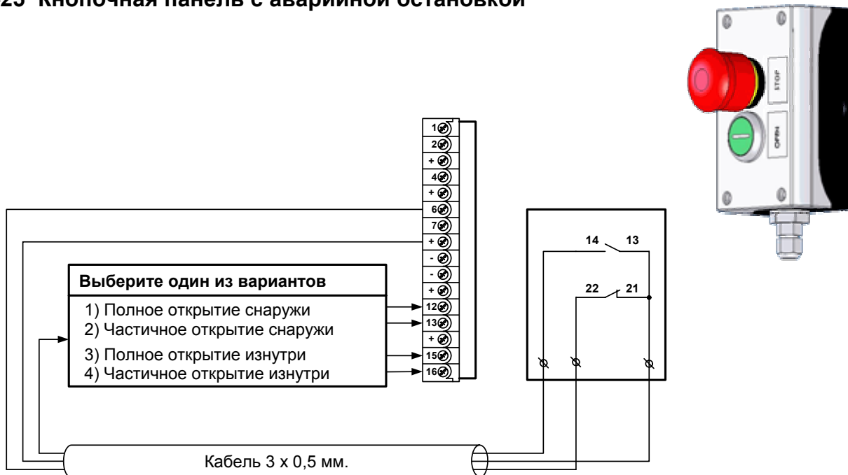
Сх.-25 Кнопочная панель с аварийной остановкой
